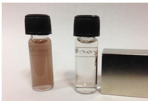
شکل ۱. نانوذرات Fe_3O_4@Au تشکیل شده و خاصیت مغناطیسی آنها
